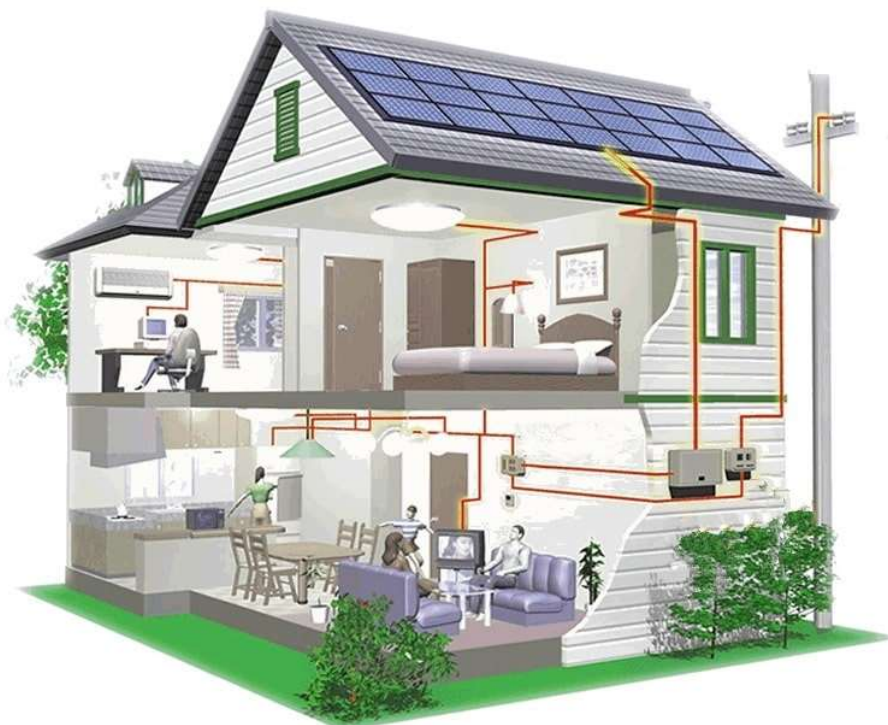
Rys. 16. Przykład domowej instalacji fotowoltaicznej (Źródło: https://pvgroup.pl/ )
